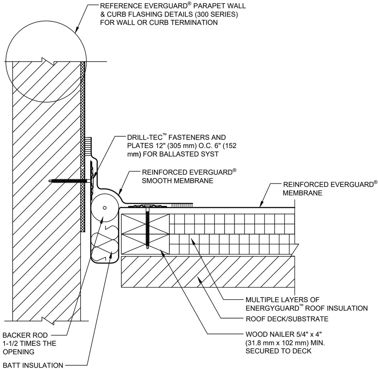
**FIELD FABRICATED WALL EXPANSION JOINT - FLAT TYPE**
