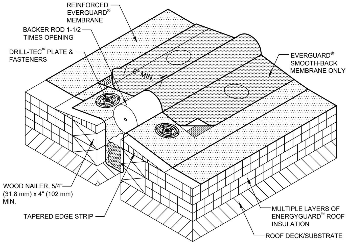
FIELD FABRICATED EXPANSION JOINT DETAIL - FLAT TYPE
